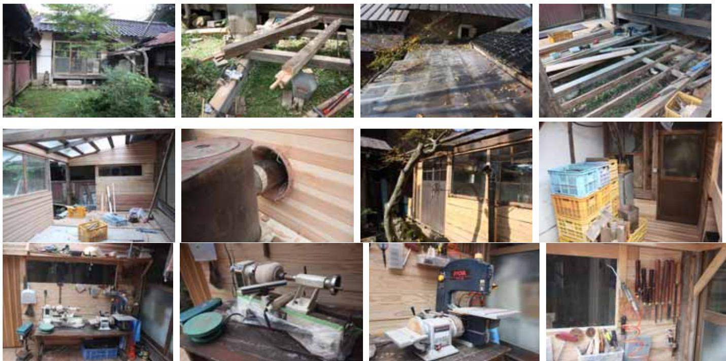
**木作業所の設備**：使いながらどんどん手を加えることで、使いやすい場所になっていく。木工旋盤、チャックを挟む穴をあけるボール盤、中心を出するくる盤、チェンソーで割った板を丸く切り出すバンドソー、刃物を研ぎ直すベルトグラインダー、木くずを吹き飛ばすエアコンプレッサーなどを一通りのモノが揃ってしまいました。
